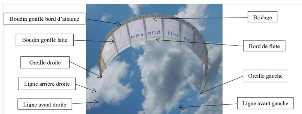
Figure 1 : Cerf-volant de 35 m<sup>2</sup>.
